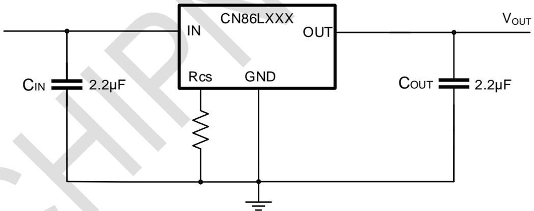
注：一般应用电路均推荐输入电容  $C_{IN}=2.2\mu F$ ，靠近芯片输入端；输出电容  $C_{OUT}=2.2\mu F$ ，靠近芯片输出端。
